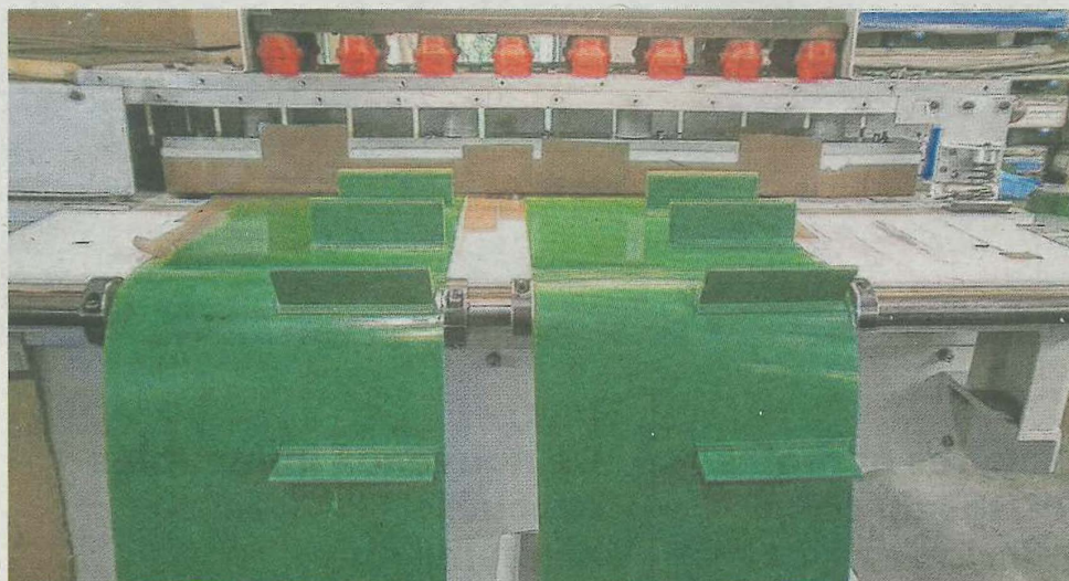
Certaines bandes sont équipées de tasseaux, notamment pour maintenir les produits convoyés.
